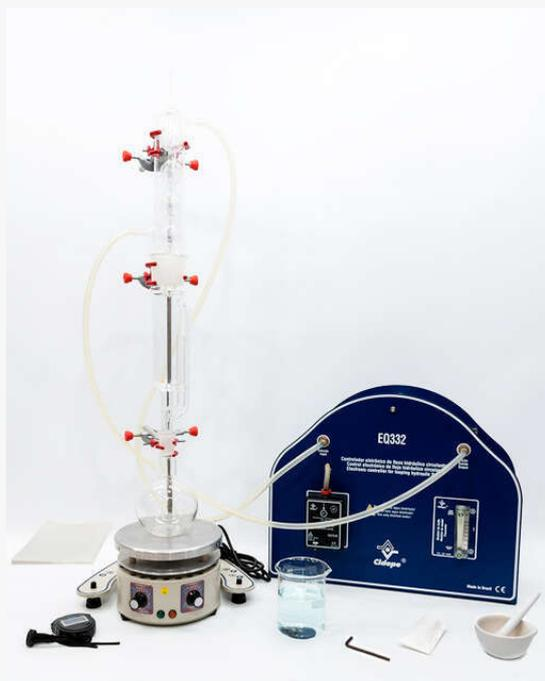
Conjunto extrator Soxhlet, com controlador de fluxo hidráulico em circuito fechado, cronômetro e aquecedor
