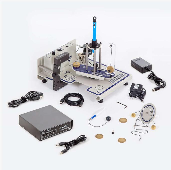
Aparelho dinâmica das rotações, força centrípeta, pêndulo cônico, carrossel, interface, sensor
