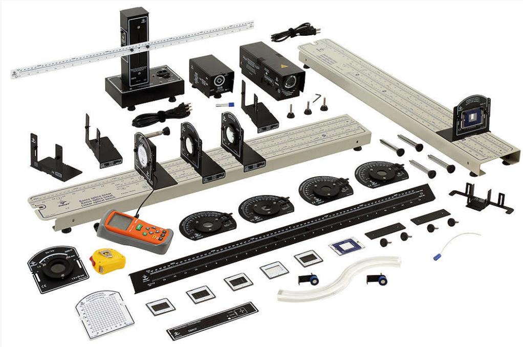
Banco óptico lineal, doble bus, rayos espectrales de mercurio, linternas monocromáticas y policromáticas.
