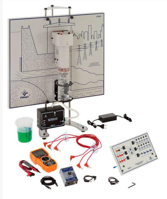
Kit para energía renovable, hidroeléctrica con unidad consumidora y multímetro.
