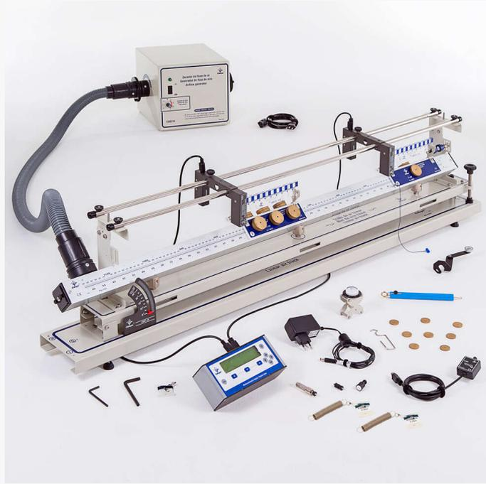
Riel de aire con multicronómetro con desplazamiento de datos, 2 sensores y unidad de flujo
